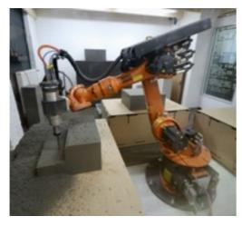
Mit dem neuen 6-Achs-Fräsroboter können die Modelle noch individueller gefräst und eilige postoperative Versorgungsanfragen noch schneller umgesetzt werden.
