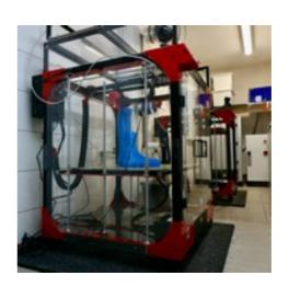
Durch den Einsatz der 3D-Drucker hat sich die Fertigungszeit von Orthesen, Prothesen und Korsetts deutlich verkürzt
