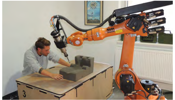
Ein 6-Achs-Fräseboter vereinfacht und beschleunigt die Fertigung von Sitz- und Liegeschalen. FOTO: ANNEKE TAUTE
