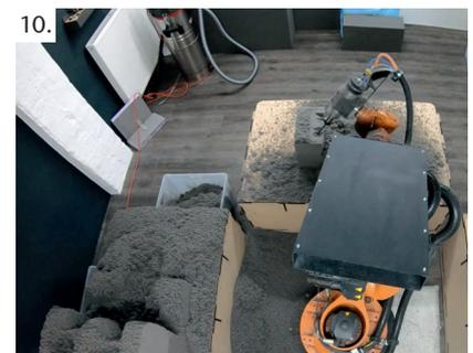
Abb. 8-10 Das am PC erstellte Positivmodell der Sitzschale wird auf den 6-Achs-Fräserroboter übertragen und kann auch über Nacht gefräst werden.
