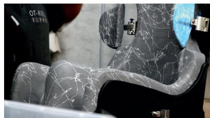
**Abb. 12** Beispiel eines fertigen Außenkorpus mit beschichteter Innenschale.
