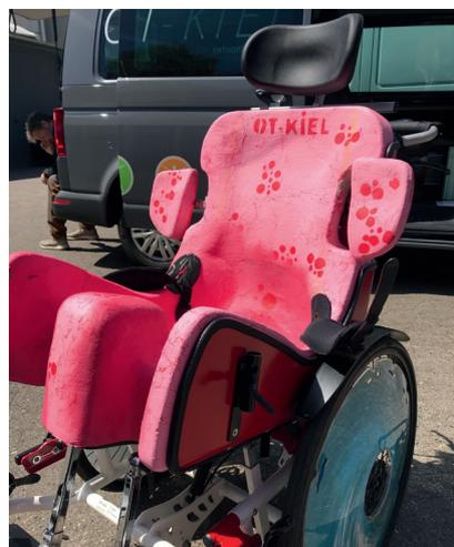
**Abb. 13** Beispiel einer fertigen Sitzschale zur Anprobe, noch ohne Bezug.
