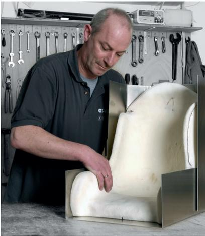
**Abb. 11** Fertigung eines Außenkorpus mit unbeschichteter Innenschale.
